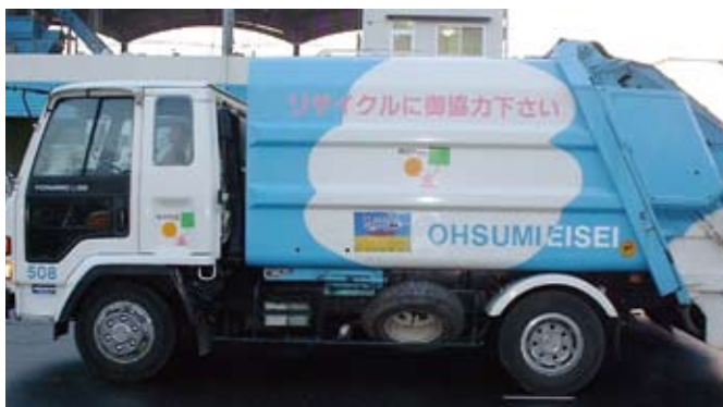
▶「家庭から出された廃食油を精製した軽油代替燃料で走るごみ収集車」
