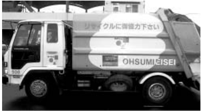
家庭から出された廃食油を精製した軽油代替燃料で走るごみ収集車
