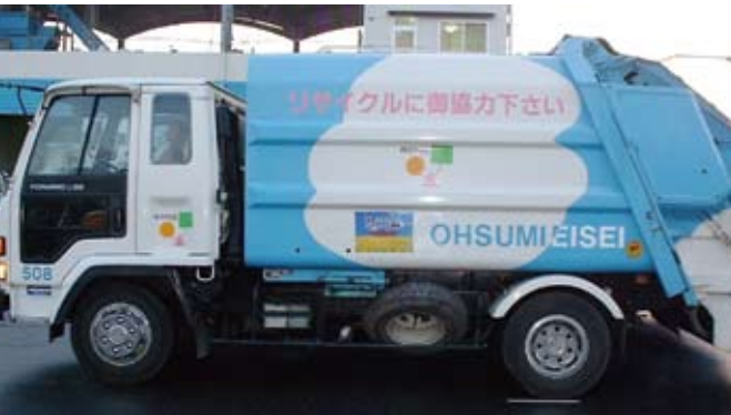
▶「家庭から出された廃食油を精製し、軽油代替燃料で走る」ごみ収集車
