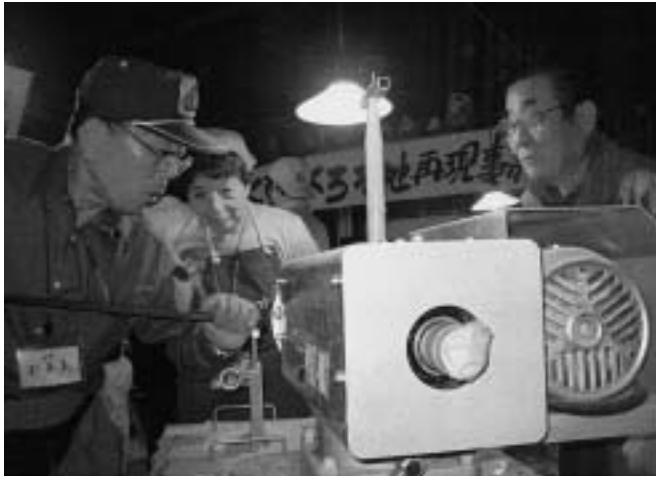
素人の体験にも危険のない旋盤型の木工口クロ
